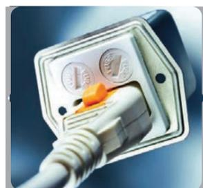
O sistema de trava V-Lock, desenvolvido pela Schurter, é utilizado nos conectores de força tipo IEC em diversos padrões. É uma solução atraente e simples para evitar a desconexão involuntária. Atende vários cabos de energia específicos de cada país. O sistema tem 2 opções de corrente de trabalho para 10A e 16A. A força de extração é de 200 N.
