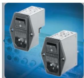
A Schurter oferece uma grande linha de tomadas com filtro de linha integrados. São vários modelos possibilitando obter em um mesmo módulo as funções de: entrada de força, porta fusível para 1 ou 2 pólos, chave liga/desliga, seletor de tensão e filtro de linha eletromagnéticos (EMC). Todos eles atendem a norma IEC 60601.
