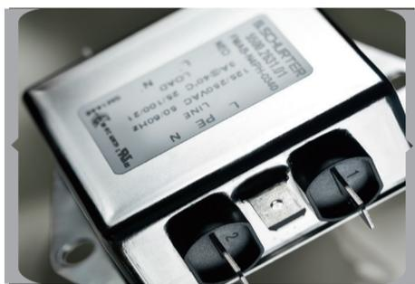
têm flange de metal para facilitar a montagem na caixa. Esta série é disponível para a gama de corrente de 1A a 30A a 250VAC de acordo com as normas IEC e UL. Possui aprovações ENEC e cURus, é adequada para aplicações de acordo com IEC 60950. As versões para equipamentos médicos estão de acordo com a IEC / UL 60601-1 com pequenas correntes de fuga <80 µA (M80) ou <5 µA (M5).
